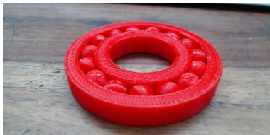
Abb. 3: 3D-gedrucktes, funktionsfähiges Kugellager
